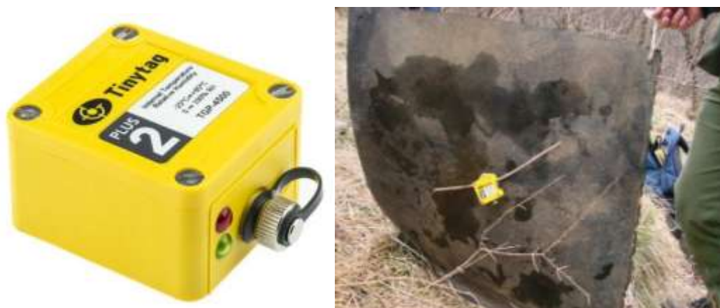
Figure 4 Capteur TGP-4500 Tinytag et son installation sous une plaque (Savier, 2017)
