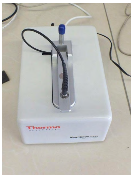
شکل ۲-۷- تصویری کلی از دستگاه نانودراپ جهت اندازه‌گیری غلظت DNA
