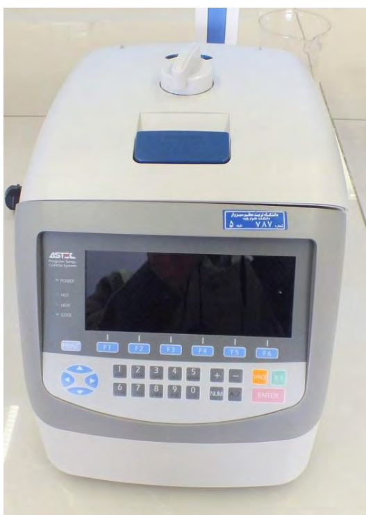
شکل ۲-۸- دستگاه PCR به نام شرکت ASTEC که برنامه مربوط به هر نوع پرایمر را برای آن تعریف می‌کنیم و در مدت زمان مشخص برنامه را اجرا می‌نماید.
